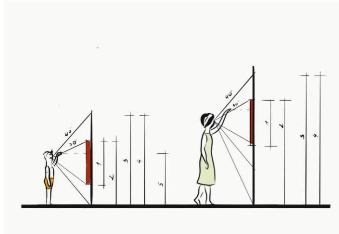
Рисунок 8 – 1. Верхний предел зрительного поля; 2. Оптимальное движение глаз; 3. Усредненная линия зрения; 4. Нормальная линия взгляда стоя; 5. Нижний предел зрительного поля
